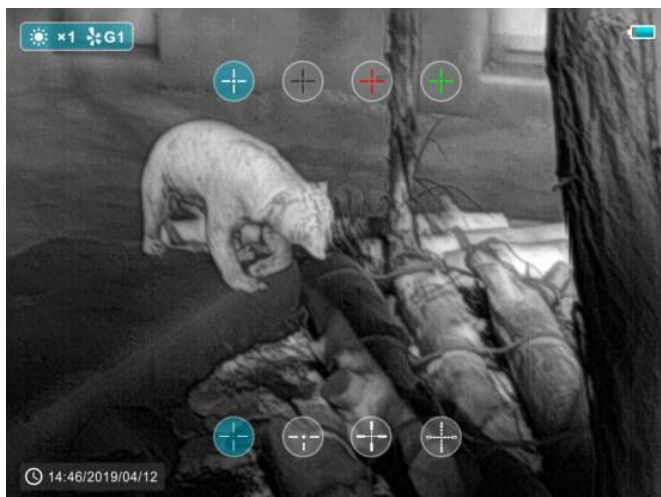
Рис. 8. Меню настройки после 4-го нажатия кнопки M
