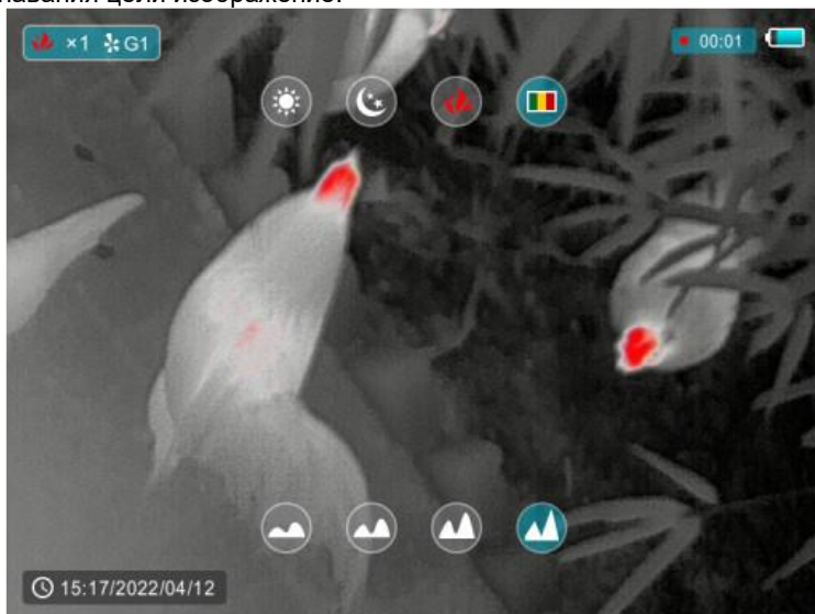
Рис. 6. Меню настройки после 2-го краткого нажатия кнопки M
